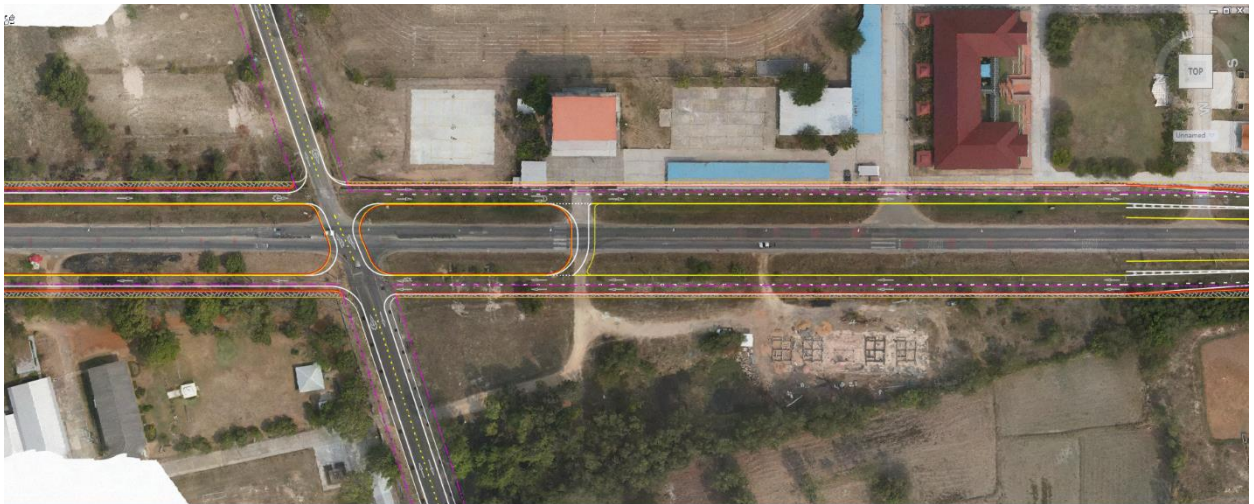
รูปที่ 5-14 การเบี่ยงจราจรเพื่อก่อสร้างตามแนวทางหลวงหมายเลข 2086 และทางหลวงหมายเลข 2085 เพื่อก่อสร้างผิวจราจรด้านนอกใหม่และปรับปรุงแนวทางเท้าและระบบที่เกี่ยวข้อง
