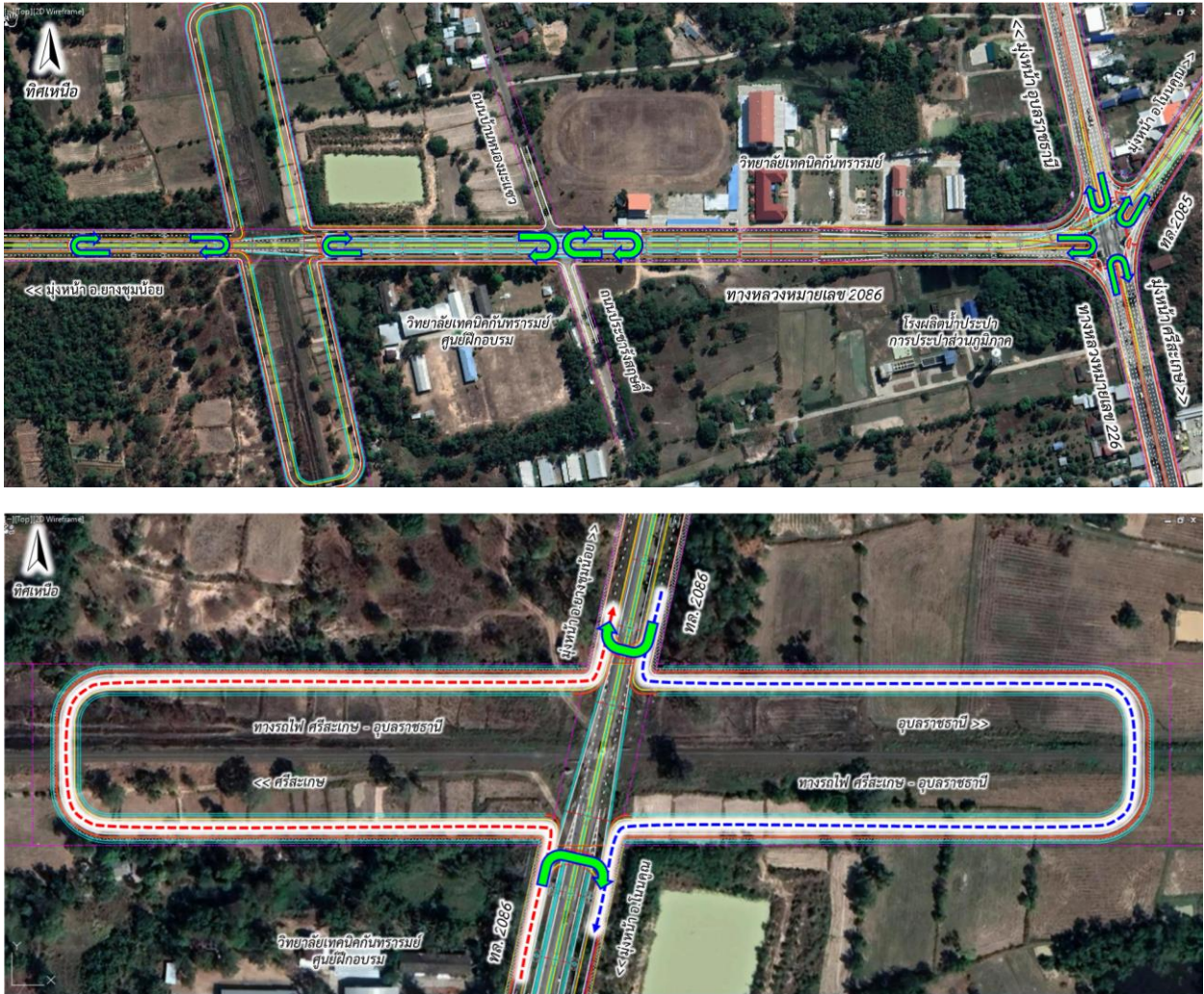
รูปที่ 5-10 การออกแบบจุดกลับรถเพิ่มเติม
