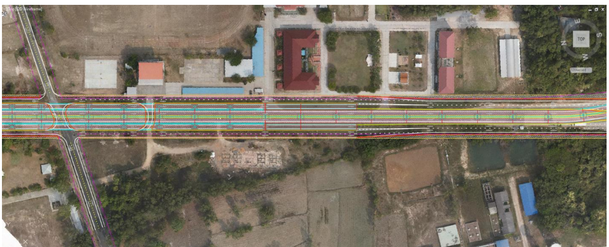
รูปที่ 5-15 การเบี่ยงจราจรเพื่อก่อสร้างตามแนวทางหลวงหมายเลข 2086 และทางหลวงหมายเลข 2085 เพื่อก่อสร้างผิวจราจรสะพานยาวต่อเนื่องข้ามทางรถไฟและข้ามแยกกันทรามย์
