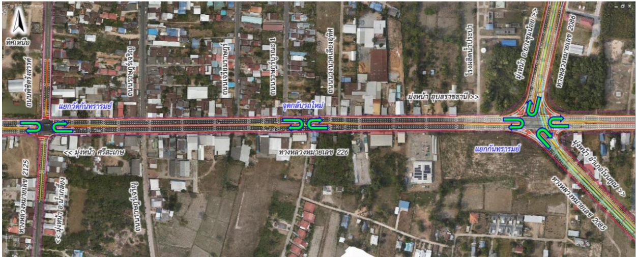
รูปที่ 5-8 การปรับปรุงจุดกลับรถ และปากทางเข้า-ออกชุมชน
