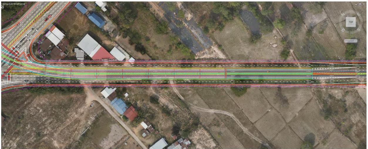
รูปที่ 5-14 การเบี่ยงจราจรเพื่อก่อสร้างตามแนวทางหลวงหมายเลข 2086 และทางหลวงหมายเลข 2085 เพื่อก่อสร้างผิวจราจรด้านนอกใหม่และปรับปรุงแนวทางเท้าและระบบที่เกี่ยวข้อง (ต่อ)
