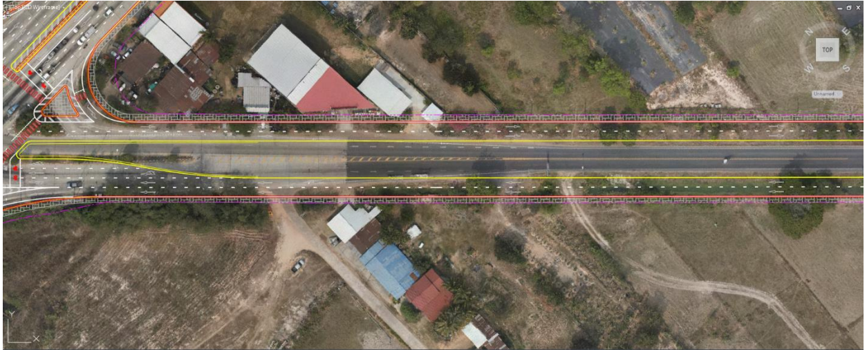
รูปที่ 5-14 การเบี่ยงจราจรเพื่อก่อสร้างตามแนวทางหลวงหมายเลข 2086 และทางหลวงหมายเลข 2085 เพื่อก่อสร้างผิวจราจรด้านนอกใหม่และปรับปรุงแนวทางเท้าและระบบที่เกี่ยวข้อง (ต่อ)
